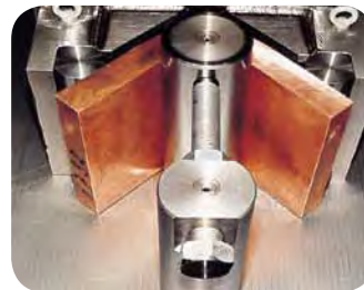
30mm vastagságig hajlítás Bending thickness up to 30 mm
